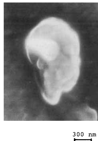
Abb. 9. Raster-Transmissions-Elektronenmikroskop-Aufnahme von Olivinteilchen; Kontaminationskegel. Bedingungen siehe Abb. 8.
